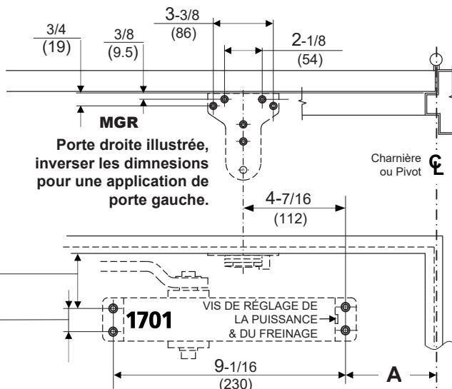
Pour un fonctionnement correct du ferme-porte, le ferme-porte et le bras parallèle doivent être de niveau sur toute l'ouverture de la porte.
