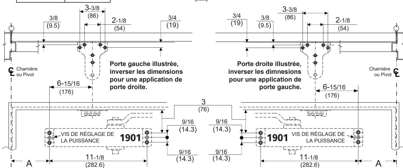
Pour un fonctionnement correct du ferme-porte, le ferme-porte et le bras parallèle doivent être de niveau sur toute l'ouverture de la porte.
