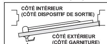
Le sens de la main est toujours déterminé lorsque l'on regarde la porte de l'extérieur (côté fermeture) vers l'intérieur. Les garnitures des dispositifs de sortie sont montées sur le côté EXTÉRIEUR d'une porte.
