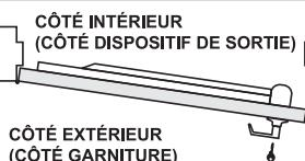
Le sens de la main est toujours déterminé lorsque l'on regarde la porte de l'extérieur (côté fermeture) vers l'intérieur. Les garnitures des dispositifs de sortie sont montées sur le côté EXTÉRIEUR d'une porte.
