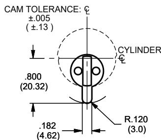
Serrure accepte les cylindres standard de 1 5/32" (29.4 mm) diamètre avec Came A (Adams Rite)
