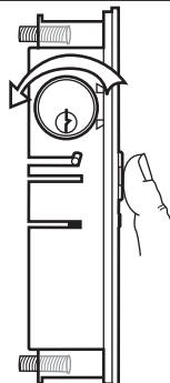
Pendant que le verrou est complètement enfoncé, tourner la clé dans la direction opposée du bord de la porte. Le verrou devrait rester rétracté permettant la porte d'être déverrouillée.
