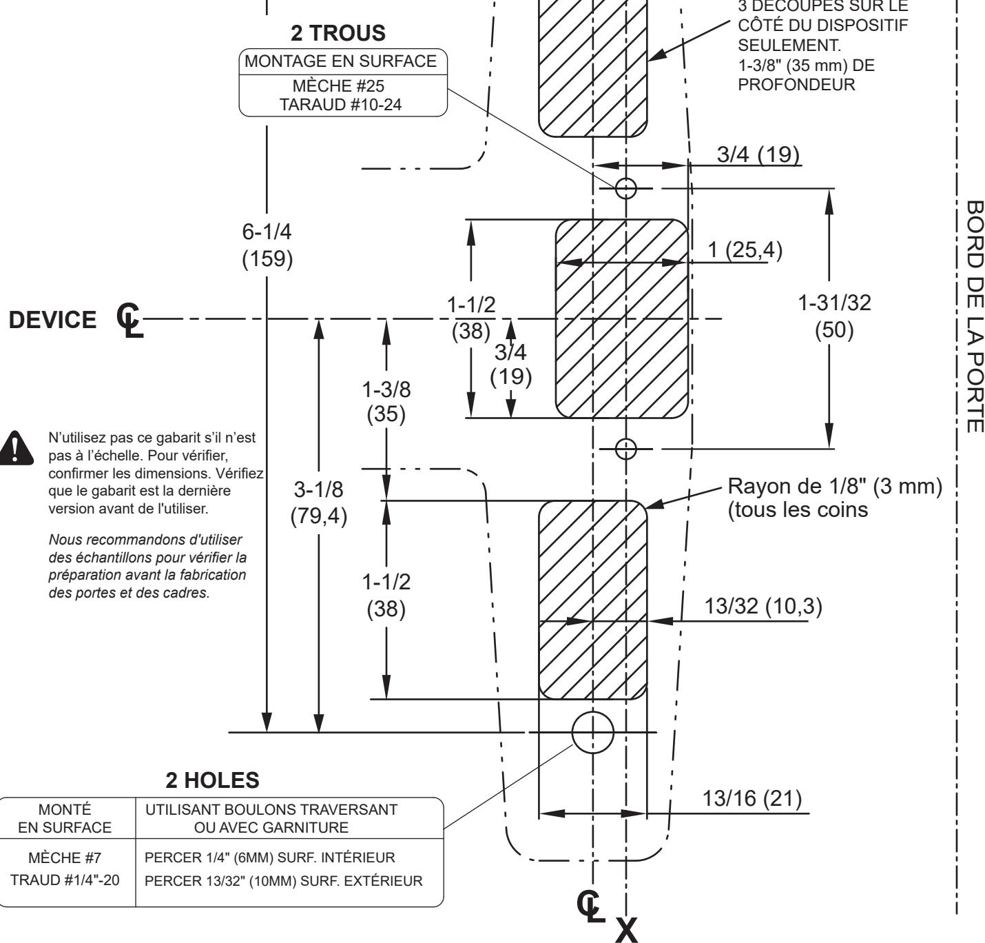
LA LIGNE X-X EST UNE LIGNE DE RÉFÉRENCE POUR L'ALIGNEMENT DES GARNITURES ET DES DISPOSITIFS DE SORTIE. LA LIGNE X-X ILLUSTRÉE ICI DOIT CORRESPONDRE À LA LIGNE X-X DES INSTRUCTIONS D'INSTALLATION DE LA GARNITURE.
