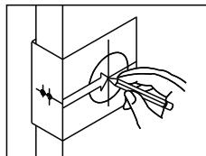
Sélectionner la hauteur et l'écartement désiré sur la surface de la porte; utiliser le GABARIT afin de marquer le centre du cercle sur la surface de la porte et le centre du bord de la porte.
