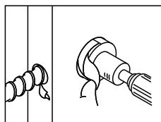
En utilisant les marques comme guide, percer un trou de Ø 2-1/8" (54mm) à travers la surface de la porte pour la serrure, percer ensuite un trou de Ø 1" (25.4mm) pour le pêne.
