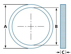
• Contre-écrou de blocage fileté en laiton massif pour cylindre mortaise de  $1\frac{5}{32}$ " (29 mm)
