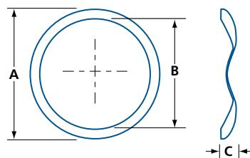
• Rondelle à ressort en acier inoxydable pour cylindre mortaise de  $1\frac{5}{32}$ " (29 mm)
