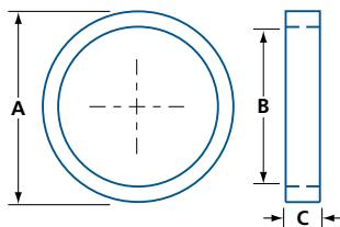
• Espaceur ou anneau de blocage en aluminium massif pour cylindre mortaise de  $1\frac{5}{32}$ " (29 mm)
