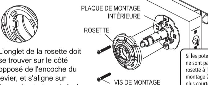
L'onglet de la rossette doit se trouver sur le côté opposé de l'encoche du levier, et s'aligne sur l'encoche du trou du levier.
