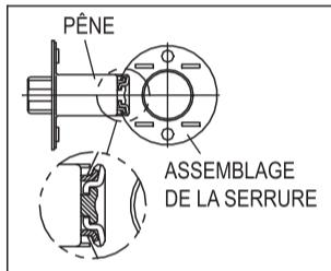
Répétez l'étape 6 pour installer les poteaux de sécurité amovibles. Installez le levier extérieur sur la porte. Assurez-vous que la queue de le pêne s'engage correctement dans l'enrouleur, comme illustré à gauche.
